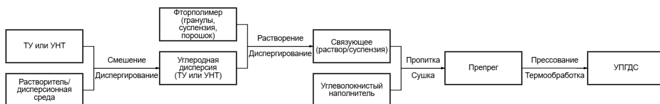
Рисунок 2 – Технологическая блок-схема получения УПГДС с комбинированным наполнителем
