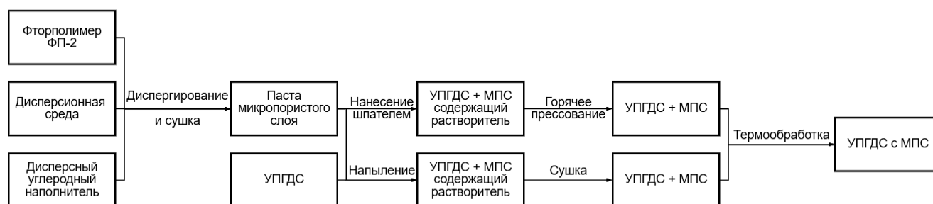
Рисунок 8 – Технологическая блок-схема получения УПГДС с МПС методами напыления или прессования
