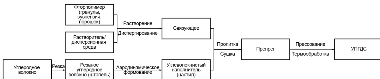
Рисунок 6 – Технологическая блок-схема получения УПГДС на основе УБ
