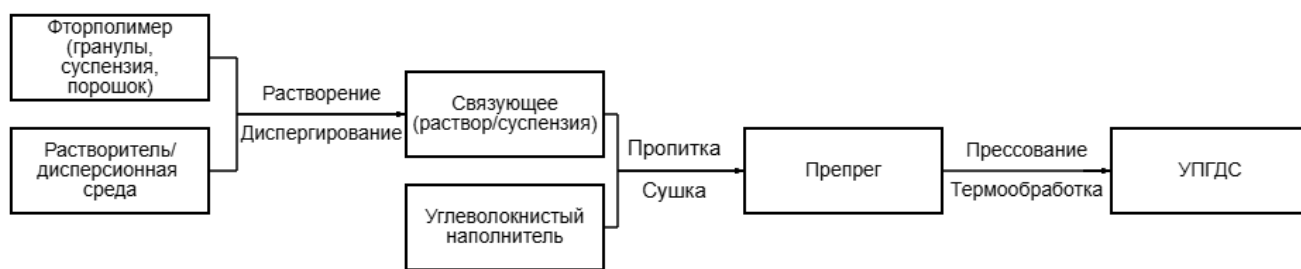
Рисунок 1 – Технологическая блок-схема получения УПГДС с непрерывным наполнителем
