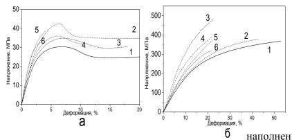
Рисунок 5 Диаграммы растяжения a) неориентированных, ориентированных композитных волокон: 1чистый полипропилен; наполненные 1 мас.%: наполненные 3 мас.%; наполненные 5 мас.% наполненные 10 мас.% и 6 наполненные 20 мас. % нановолокон.
