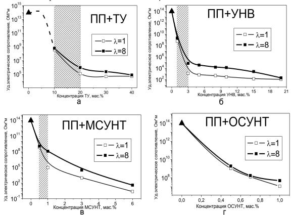
Рисунок 4 — Значения удельного электрического сопротивления волокон, наполненных: а) - техническим углеродом; б) — нановолокнами; в) — многостенными и г) — одностенными нанотрубками. □ - неориентированные волокна, ■ — ориентированные волокна. Значение р<sub>v</sub> для чисто ПП обозначено - ▲. Заштрихованная область — порог протекания электрического тока.
