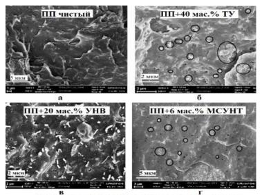
Рисунок 12 — Микрофографии поперечных сколов композитных волокон, полученные в жидком азоте. Черным цветом выделенные дисперсные частицы и их агрегаты.
