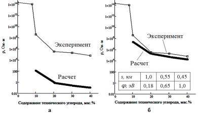
Рисунок 15 - Сравнение экспериментальных значений удельного сопротивления композитного волокна, наполненного ТУ, с теоретическими данными рассчитанными по фомуле 1 (а) и 2 (б)
