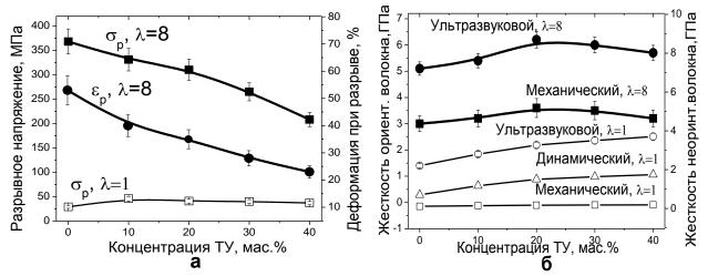
Рисунок 6 – Зависимости а) – прочности и деформации при разрыве, б) – модулей жесткости волокон от концентрации технического углерода и степени вытяжки (λ). Темные символы – ориентированные волокна, светлые символы – неориентированные волокна.
