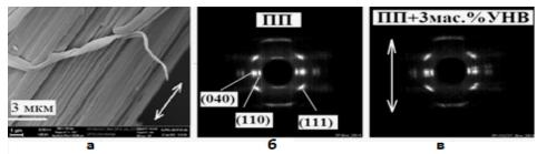
Рисунок 13 - Продольный скол ориентированного волокна, содержащего 3мас.%УНВ (а); Фоторентгеннограммы волокон: чистый ПП (б) и волокно, содержащее 3мас.%УНВ (в). Направление экструзии показано стрелкой.
