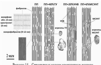
Рисунок 14 – Структурные модели композитных волокон
