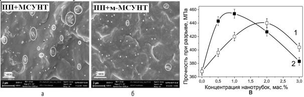
Рисунок 11 - Микрофотографии ПП волокон, наполненных а) - 1 мас.% МСУНТ и б) - 1 мас.% м-МСУНТ; в) - Изменение прочности при разрыве волокна от концентрации наполнителя: МСУНТ (1); м-МСУНТ (2). Белым контуром выделены некоторые агрегаты нанотрубок, а местоположение отдельных нанотрубок — белыми точками.
