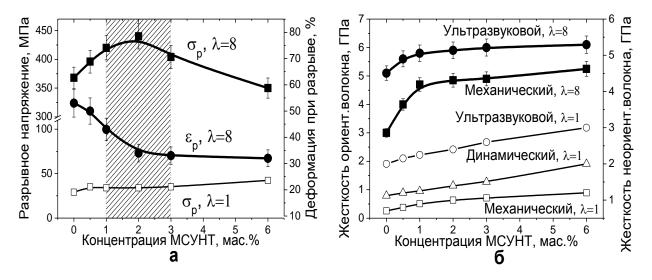
Рисунок 8 – Зависимости а) – прочности и деформации при разрыве, б) – жесткости волокон от концентрации многостенных нанотрубок и степени вытяжки (λ). Темные символы ориентированные волокна, светлые символы – неориентированные волокна.
