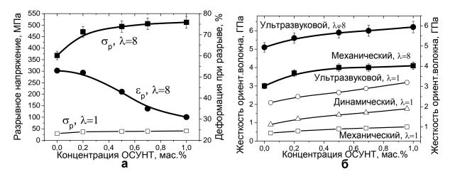
Рисунок 9 – Зависимости а) – прочности и деформации при разрыве, б) – жесткости волокон от концентрации одностенных нанонтрубок и степени вытяжки (λ). Темные символы – ориентированные волокна, светлые символы – неориентированные волокна.
