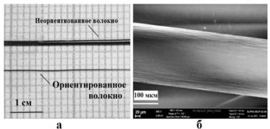
${f a}$  Рисунок 3 – a) - Макро- и б) - микрофотографии композитных волокон.
