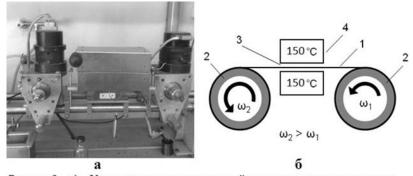
Рисунок 2-a) — Установка для ориентационной вытяжки исходных волокон и б) - Схема установки: 1 — волокно; 2 — вальцы, вращающиеся с различными угловыми скоростями; 3 — область, нагретая до 150 °C; 4 — электронагреватель.
