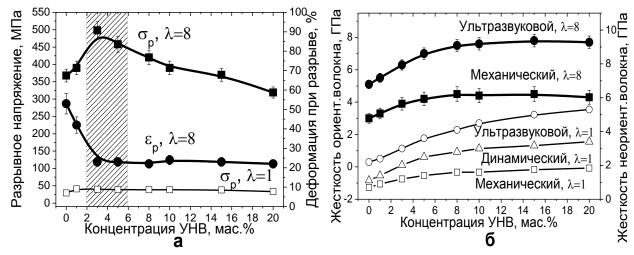
Рисунок 7 – Зависимости а) – прочности и деформации при разрыве, б) – модулей жесткости волокон от концентрации нановолокон и степени вытяжки (λ). Темные символы – ориентированные волокна, светлые символы – неориентированные волокна.
