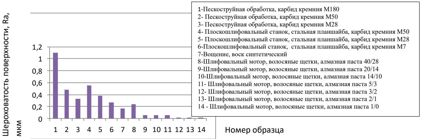
Рисунок 7 – Зависимость качества поверхности от вида ее обработки
