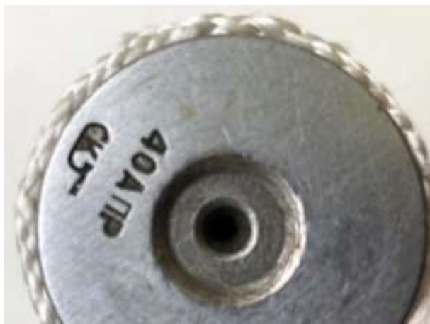
Рисунок 11 – Шнур ШОАН(К) – 2,5, изогнутый на цилиндре диаметром 40 мм
