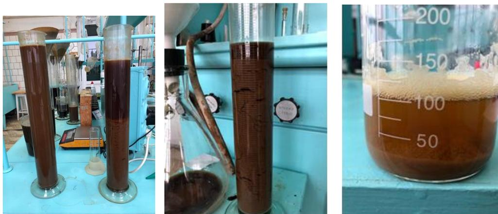
Рисунок 5 – Осадок, полученный осаждением лигнинного комплекса жидкостью, насыщенной диоксидом углерода с нуклеаторами, и обработкой серной кислотой
