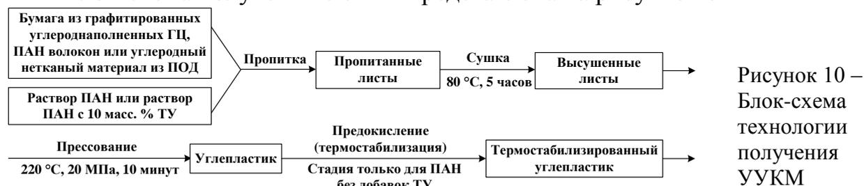
Рисунок 10 – Блок-схема технологии получения УУКМ
