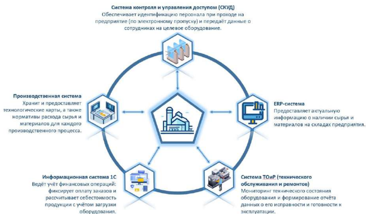
Рисунок 2.3 – Схема сетецентрического управления
