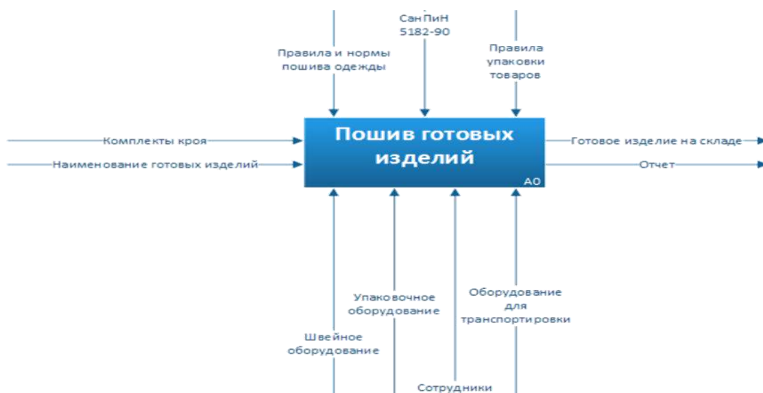
Рисунок 3.17 – Диаграмма реализации модуля «пошив готовых изделий» ИАС
