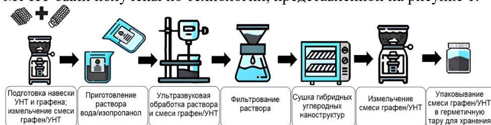
Рисунок 1 – Технология получения гибридных углеродных наноструктур графен/УНТ
