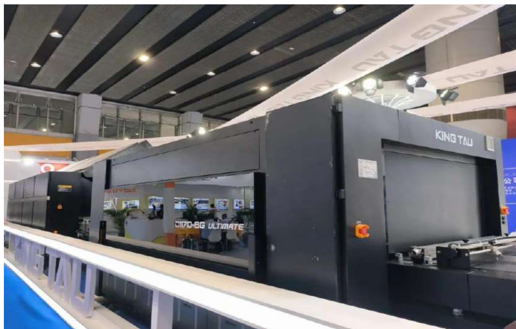
Ил. 3.17. Фотография керамического принтера для струйной печати плитки, модель D1170. Компания Guangzhou Jingtao Machinery & Electrical Equipment Co., Ltd. 2022 г. Фото создано 19 июня 2023 г.
