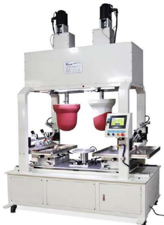
Ил. 3.16. Устройство, обеспечивающее технологию переноса изображения в керамической промышленности, модель HH-202S. Компания Dongguan CSP Machinery Co., Ltd. 2023 г.
