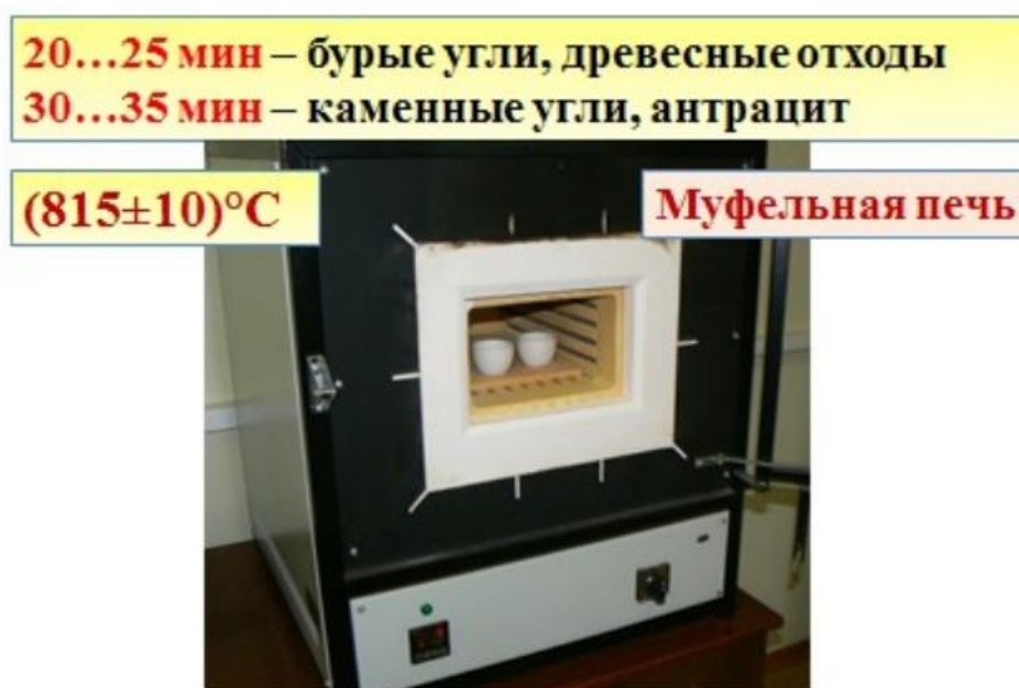
Рис 3.9 - Муфельная печь для определения зольности топлива
