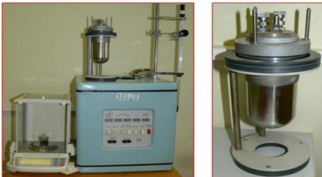
Рис. 3.10 - Калориметрическая установка и бомба Крекера
