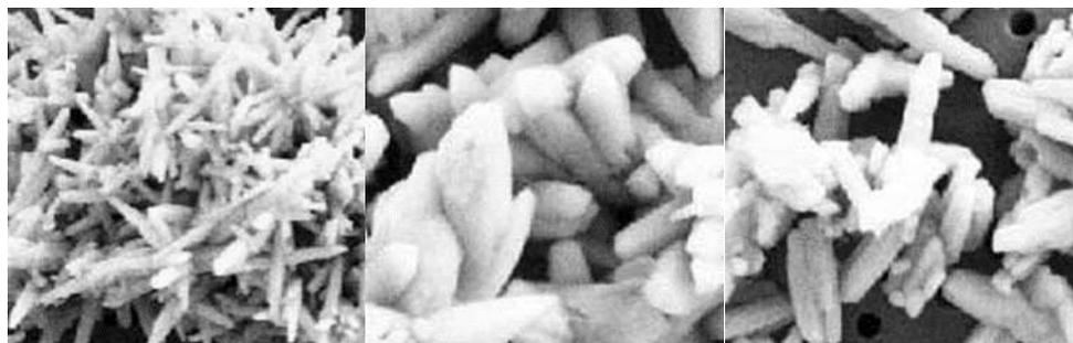
Рисунок 1.22 – Виды РСС с частицами разной формы
