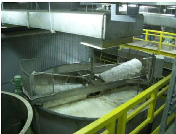
Рисунок 3.3 – Флотатор очистки стоков производства БХТММ
