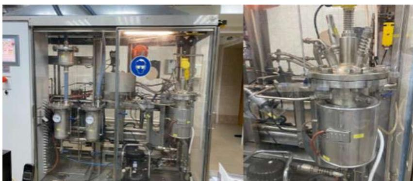
Рисунок 2.1 – Пилотная варочная установка кафедры Технологии целлюлозы и композиционных материалов ВШТЭ
