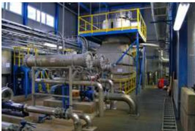
Рисунок 3.5 – Флотатор для сгущения шлама песчаных флотофильтров доочистки стоков
