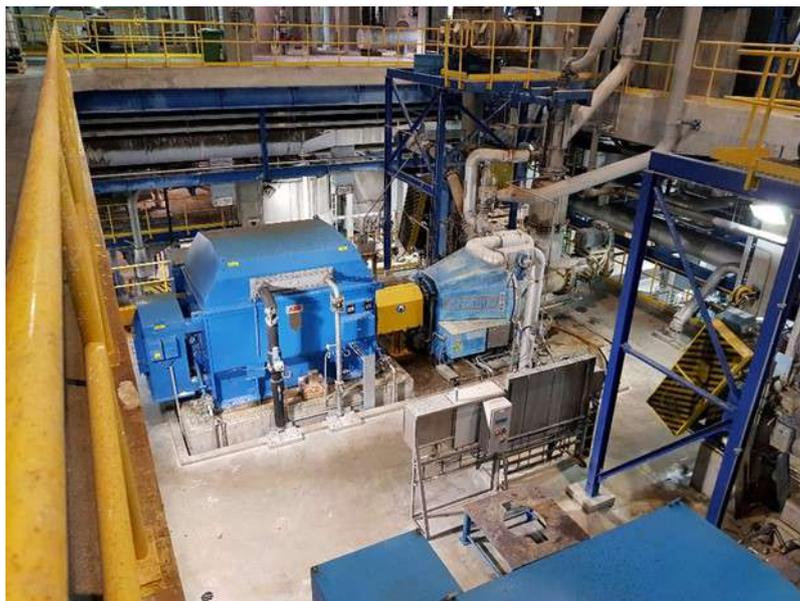
Рисунок 3.18 – Рафинер для размола ХТММ мощностью 22 МВт
