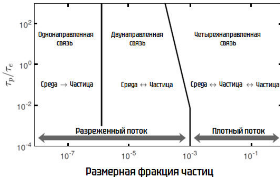
Рисунок 9. Схема режимов взаимодействия газа с твердыми частицами в турбулентных течениях. \tau_p и \tau_e — время кинетического отклика частиц и временной масштаб крупных вихрей в турбулентном потоке соответственно [79].
