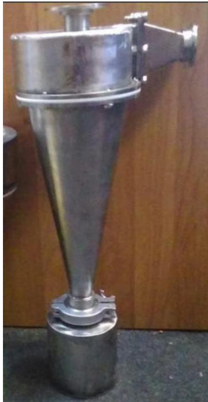
Рисунок 24. Конструкция изготовленного циклона с бункером в собранном виде
