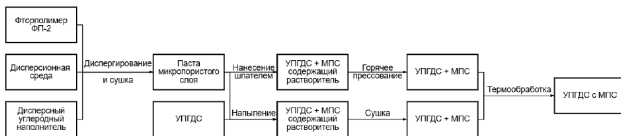
Рисунок 4.1 – Технологическая блок-схема получения УПГДС с МПС напылением или прессованием пасты МПС на УПГДС
