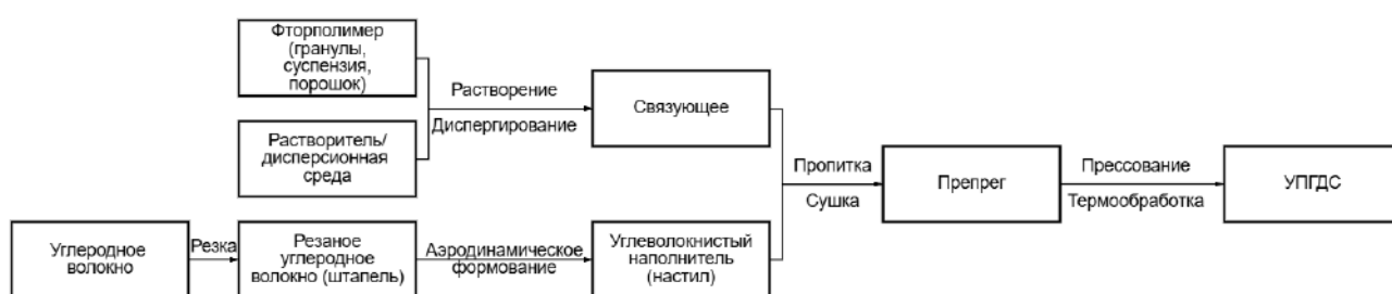
Рисунок 3.48 – Технологическая блок-схема получения УПГДС на основе УБ
