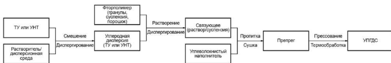
Рисунок 3.12 – Технологическая блок-схема изготовления УПГДС с комбинированным непрерывным и дисперсным углеродным наполнителем
