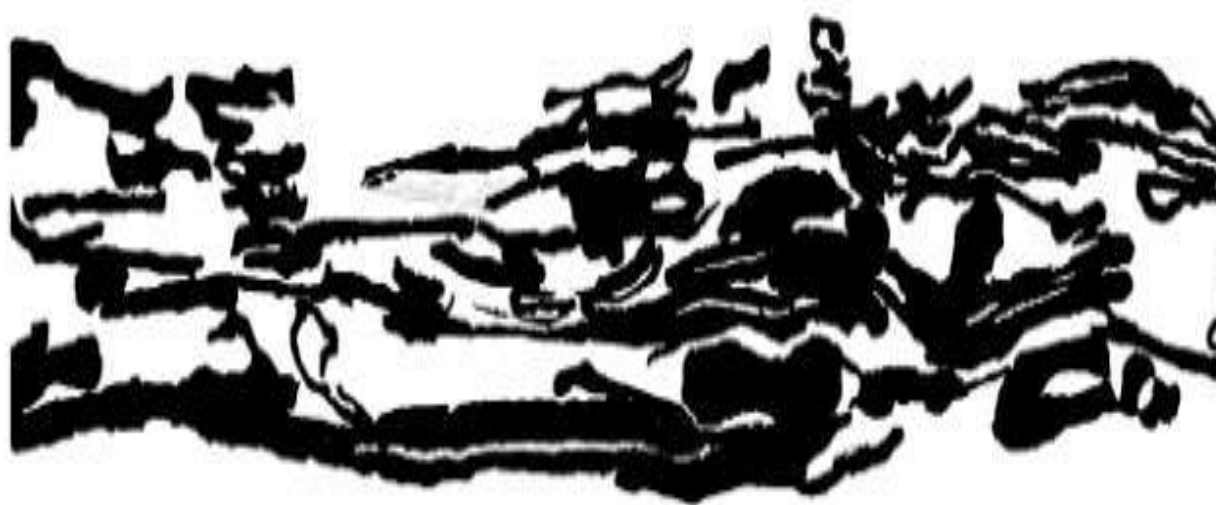
Рисунок 3.6 – Результат графической обработки изображения микроструктуры поперечного среза двухслойного картона
