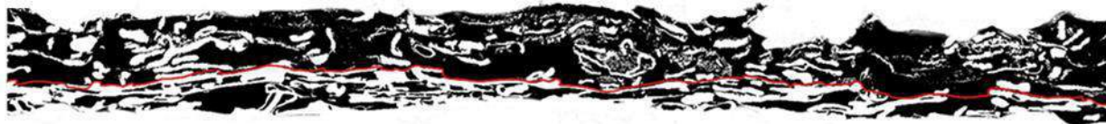
Рисунок 1.20 – Пористость картона, определенная по микроструктуре поперечного среза [25–27]
