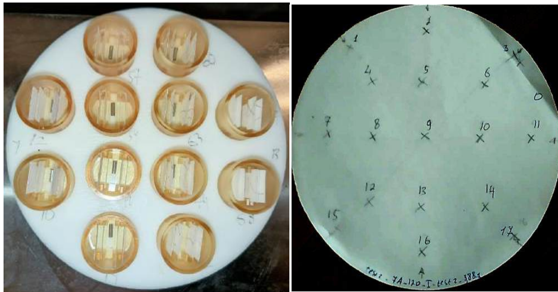
Рисунок 2.8 – Подготовка образцов картона к графической обработке микроструктуры: a – зафиксированные образцы перед заливкой в прозрачный синтетический полимер; б – схема разделения отливки на сектора для проведения измерений
