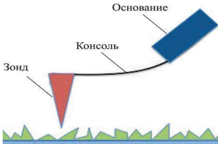
Рисунок 1.8 – Схема работы атомносилового микроскопа [60]
