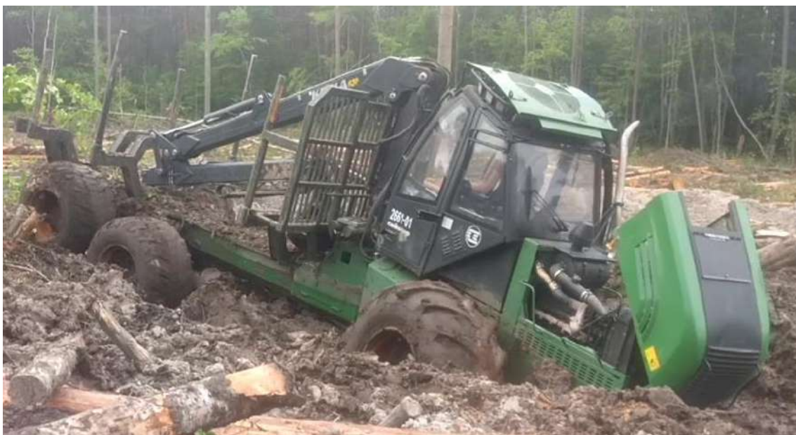
Рисунок 1.17. «Затопление» колесного форвардера при плохих почвенно-грунтовых условиях
