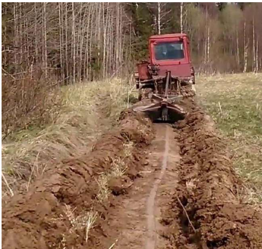
Рисунок 4.1. Гусеничный трактор ДТ-75, агрегатированный двухотвальным лесным плугом, на прокладке противопожарной минерализованной полосы
