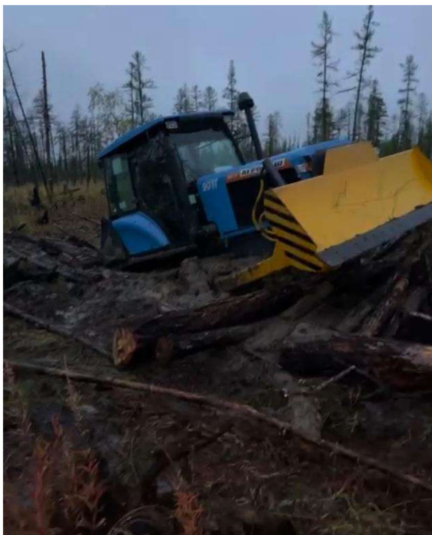
Рисунок 4.3. Работа гусеничного бульдозера на расчистке гари под компенсационное искусственное лесовосстановление (Республика Саха (Якутия), июнь 2023 г.)
