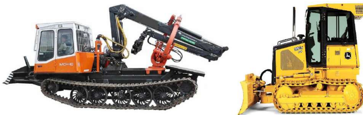
Рисунок 1.9. Визуальное сравнение ходовой части лесного и строительного тракторов
