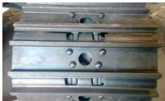
Лесной трак гусеничного харвестера - 700 мм, 2 грунтозацепа
