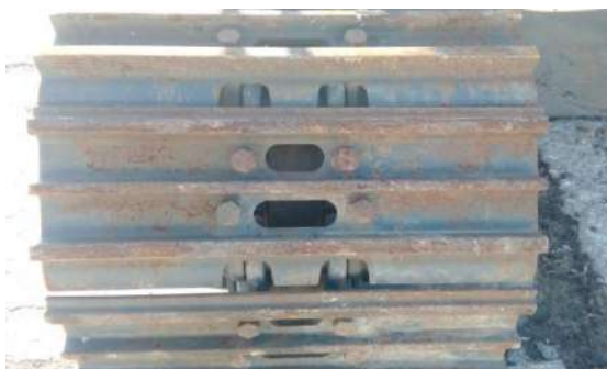
Заводской трак экскаватора - 600 мм, 3 грунтозацепа
