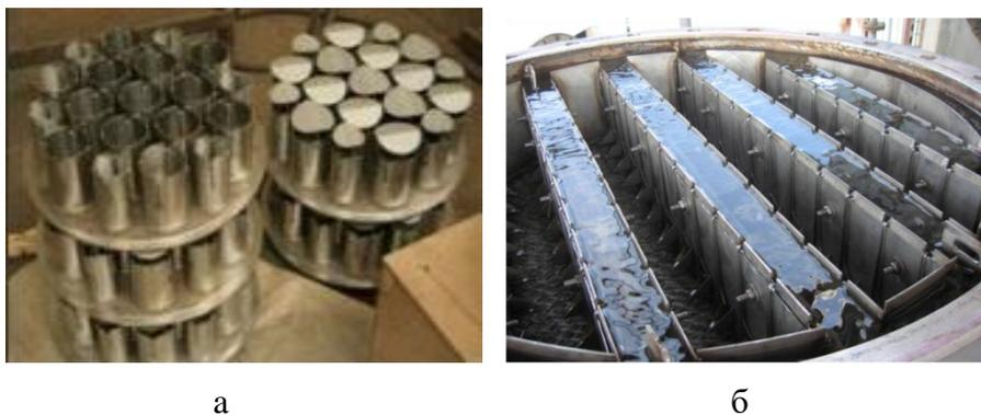
Рисунок 5.5 Распределители жидкости: а) патрубковый; б) желобчатый
