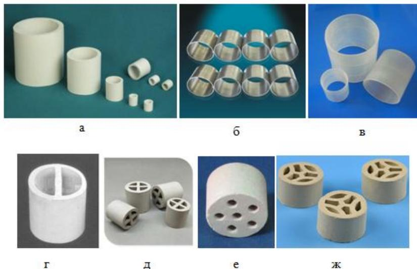
Рисунок 1.4 Кольца Рашига: а – керамические; б – металлические; в – пластмассовые; г – с одной перегородкой; д – с крестообразной перегородкой; е - со сквозными отверстиями; ж – с развилинами внутри кольца.
