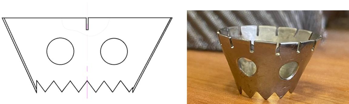
Рисунок 5.8 Воротниковый распределитель жидкости
