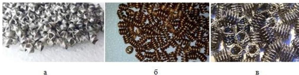
Рисунок 1.11 Спирально-призматические насадки: а – спираль Фенске; б – насадка Селиваненко; в – насадка Левина
