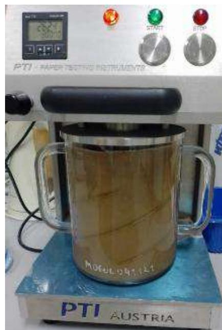
Рисунок 2.21 – Дезинтегрирование макулатуры для получения волокна
