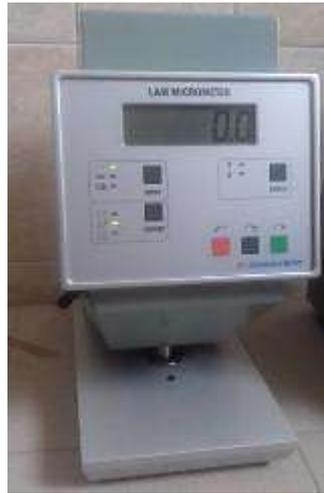
Рисунок 2.25 – Цифровой микрометр Lorentzen & Wetter SE 250
