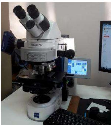
Рисунок 2.6 – Исследовательский моторизованный микроскоп высокого разрешения «Imager M2m Carl Zeiss»
