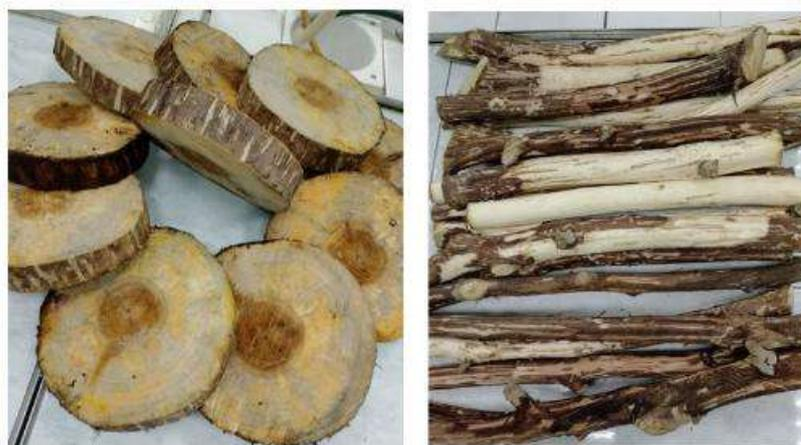
Рисунок 2.2 – Шайбы из ствола и ветви осины после снятия коры
