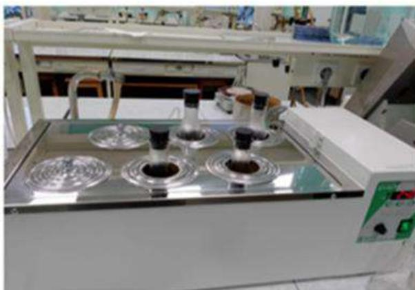
Рисунок 2.7 – Экстракция с холодной водой
