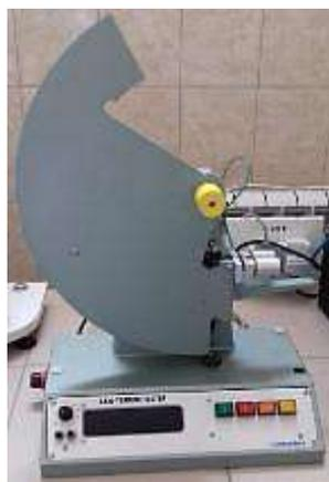
Рисунок 2.26 – Прибор для определения сопротивления раздиранию Elmendorf 09ED
