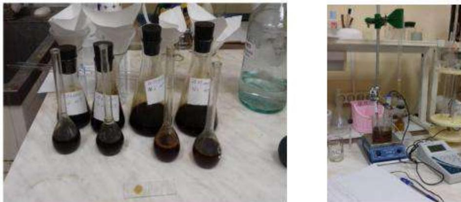
Рисунок 2.16 – Определение содержания активной щелочи в черном шлаке
