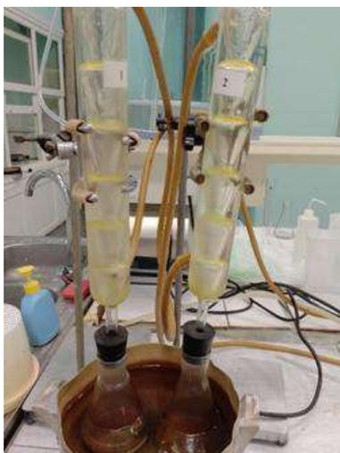
Рисунок 2.8 – Экстракция с горячей водой
