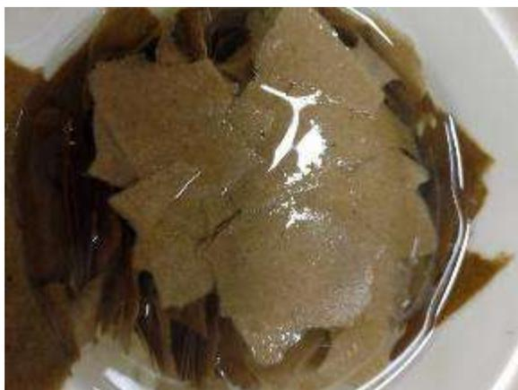
Рисунок 2.20 – Замачивание макулатуры МС-5Б в воде
