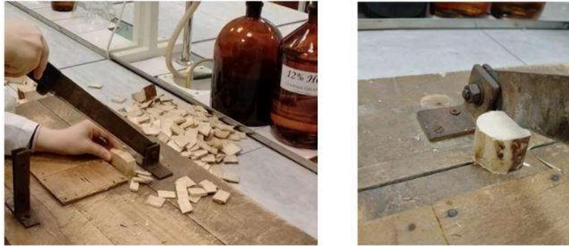
Рисунок 2.3 – Установка для изготовления щепы
