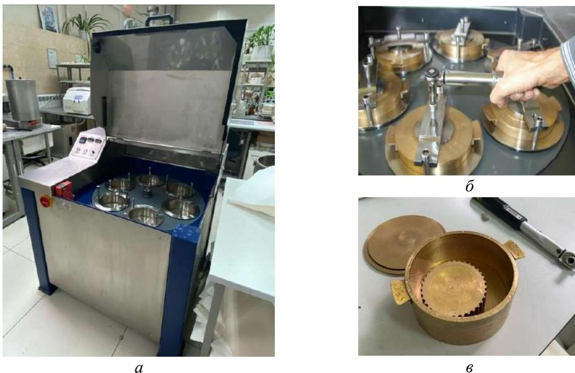
Рисунок 2.18 – Лабораторная мельница Йокро: *а* – общий вид мельницы; *б* – вращающийся горизонтальный стол с шестью ячейками для размольных стаканов; *в* – размольная единица
