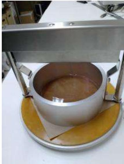
Рисунок 2.32 – Прибор для испытания влагопоглощения L&W SE 146 по Коббу
