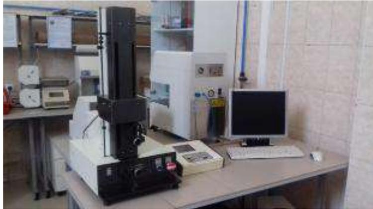
Рисунок 2.29 – Испытательная машина «ТЕСТСИСТЕМА 101» с ЭВМ
