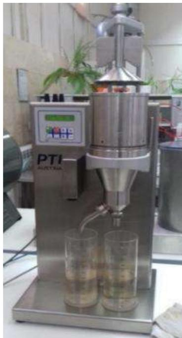
Рисунок 2.19 – Аппарат системы Шоппер-Риглер
