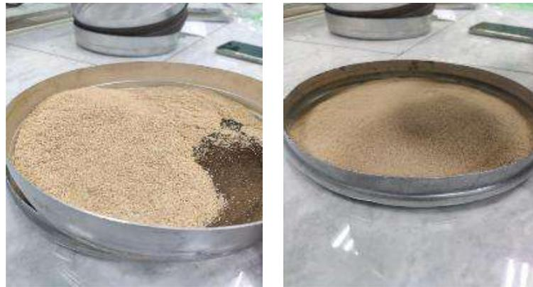
Рисунок 2.4 – Просеивание опилок
