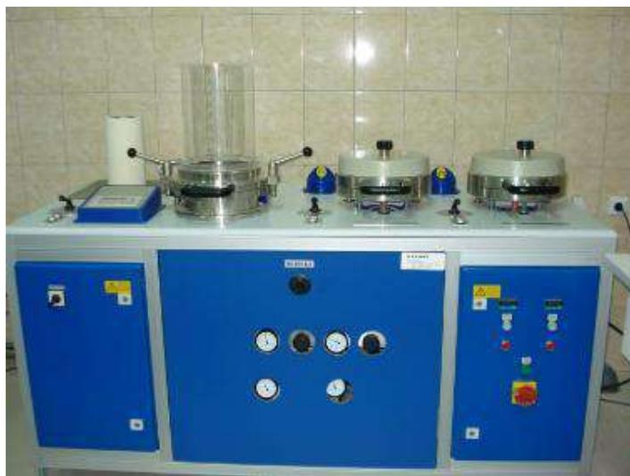
Рисунок 2.22 – Листоотливной аппарат системы Рапид-Кеттен
