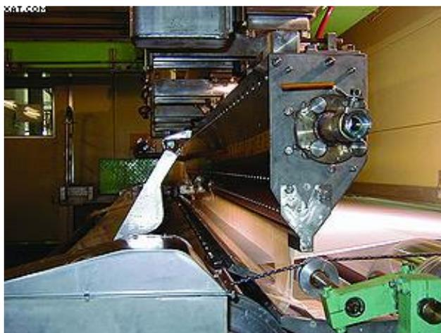
Рисунок 12 – Шторное мелование на установке фирмы Voith [106]
