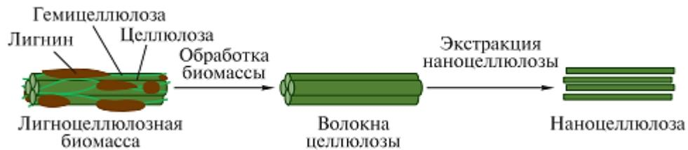
Рисунок 1– Схема получения наноцеллюлозы из биомассы
