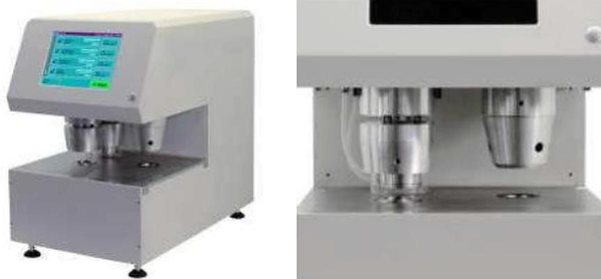
Рисунок 16 – Прибор для измерения воздухопроницаемости и шероховатости по Бендтсену
