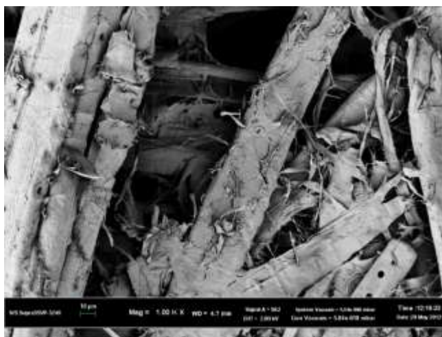
Рисунок 17 – Микрофотография ХТММ лиственницы, полученной с предварительной ферментативной обработкой целлюлазным препаратом, увеличение в 1000 раз
