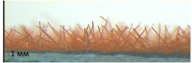
Рисунок 4 – Увеличенное изображение среза флокированного образца (время нанесения t = 8с )
