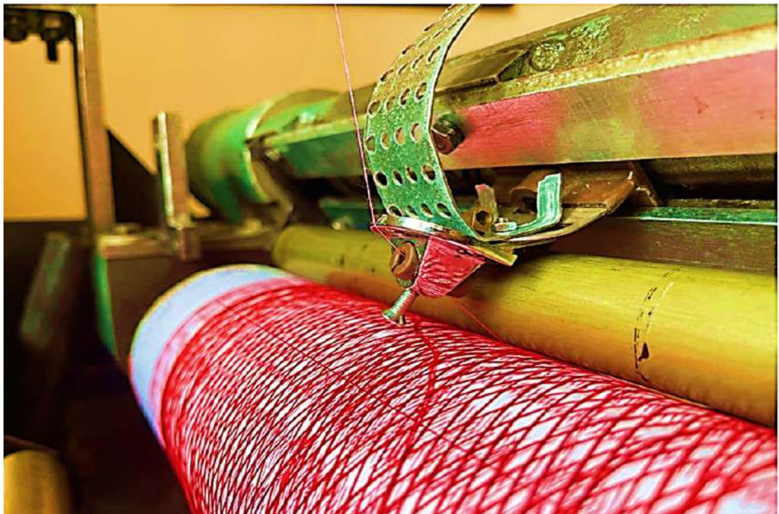
Рисунок 4.3 - Общий вид экспериментального стенда. Узел нитеводителя.
