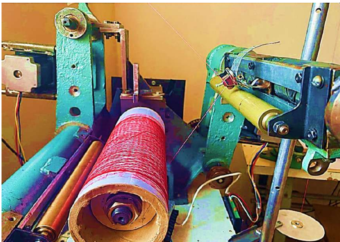
Рисунок 4.4 - Общий вид экспериментального стенда. Узел нитераскладчика.
