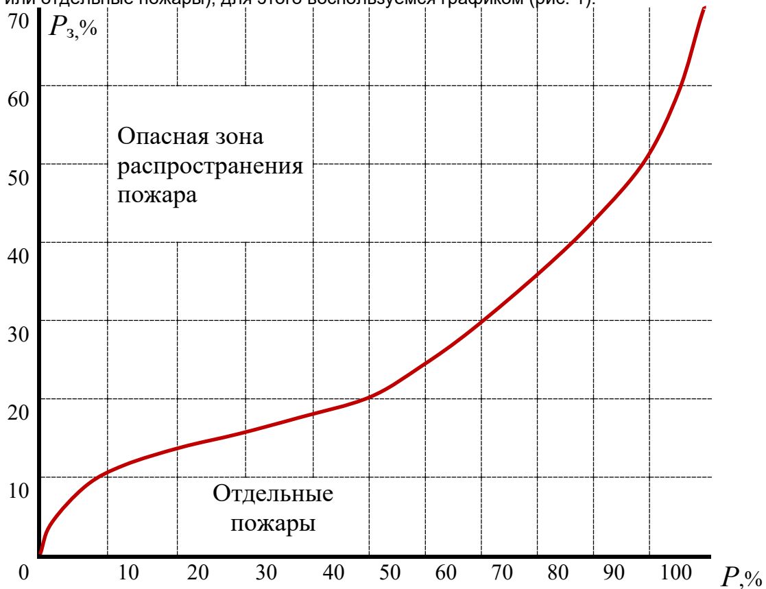
Рис. 1. Зависимость вероятности распространения пожара от плотности застройки
