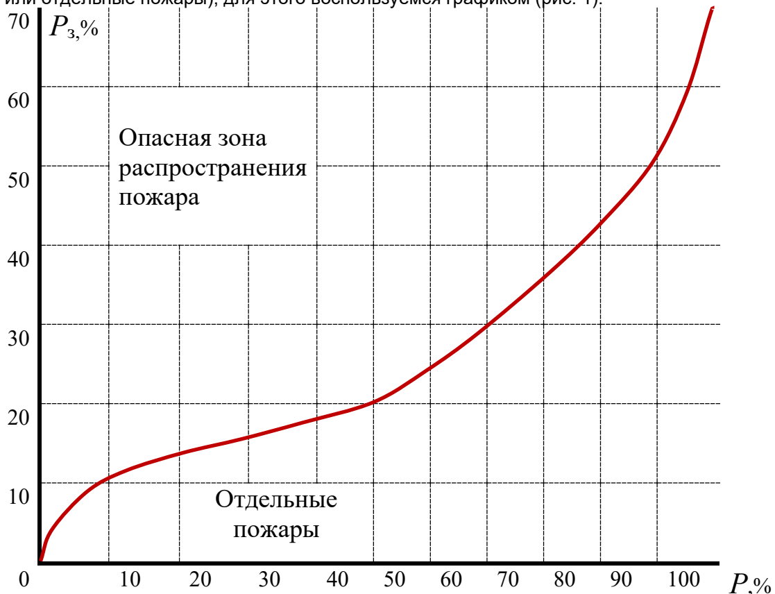
Рис. 1. Зависимость вероятности распространения пожара от плотности застройки
