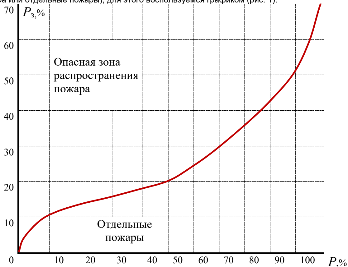
Рис. 1. Зависимость вероятности распространения пожара от плотности застройки
