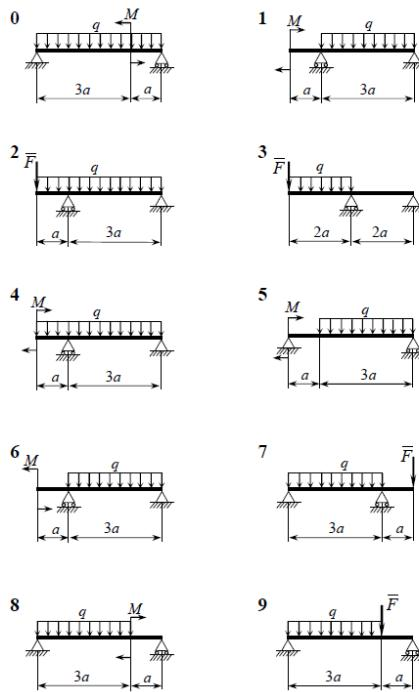
4. Дано: схемы закрепления бруса; значения параметров  $P$ ,  $M$ ,  $q$ . Определить реакции опор для того способа закрепления, при котором момент  $M_A$  в заделке имеет наименьшее значение.
