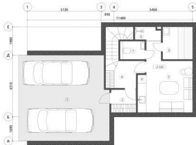
План расположения мебели и оборудования -1 этаж М 1:60
