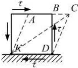
Штриховыми линиями указан характер деформации детали. Определить корректное название напряженного состояния, показанного на рисунке. Укажите угол сдвига.
