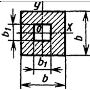
Для дальнейшей оценки нормальных напряжений в балке указанного поперечного сечения рассчитать осевой момент инерции сечений относительно оси X и Y/
