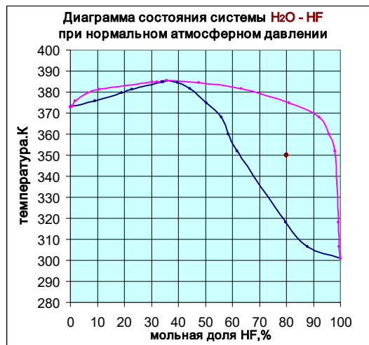
Рисунок. Диаграмма состояния системы \text{H}_2\text{O} - \text{HF}
