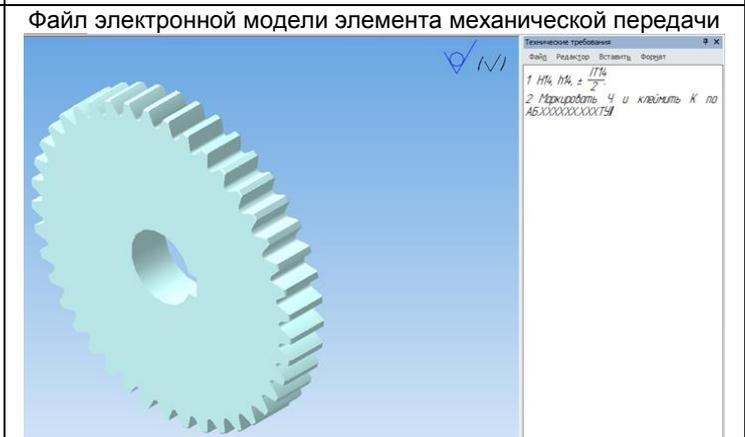
6 Добавить в электронную модель сборки стандартные изделия, используя данные справочника «Стандартные изделия». Задать свойства электронной модели. Проставить производные размеры, добавить в модель неуказанную шероховатость и технические требования. Создать ассоциативный чертёж.
