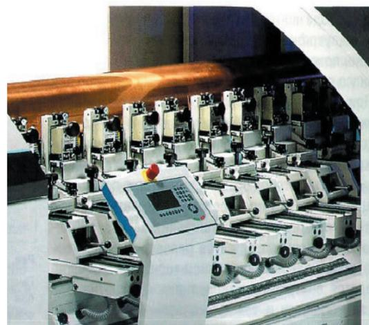
Гравировальная машина для электромеханического гравирования с 16-гравировальными головками (HelioKlischograph K 406-Sprint, HELL Gravure System)
