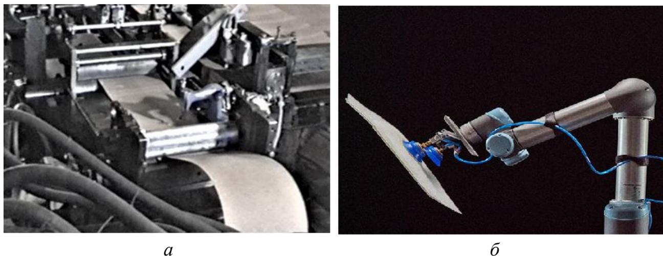
Рисунок 1 – Валковая подача полосы кожкартона в вырубочный пресс (а); вакуумный захват лоскута швейным роботом Sewbo (б)
