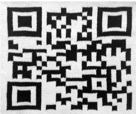
Рисунок 4 – Общий вид двойного жаккардового трикотажа с двухцветными контрастными узорными эффектами в виде QR-кода: ссылка на сайт СПбГУПТД
