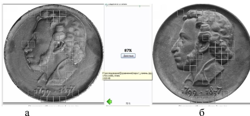
Рисунок 9. Результаты оценки воспроизводимости рельефов: а - модель ; б – отливка
