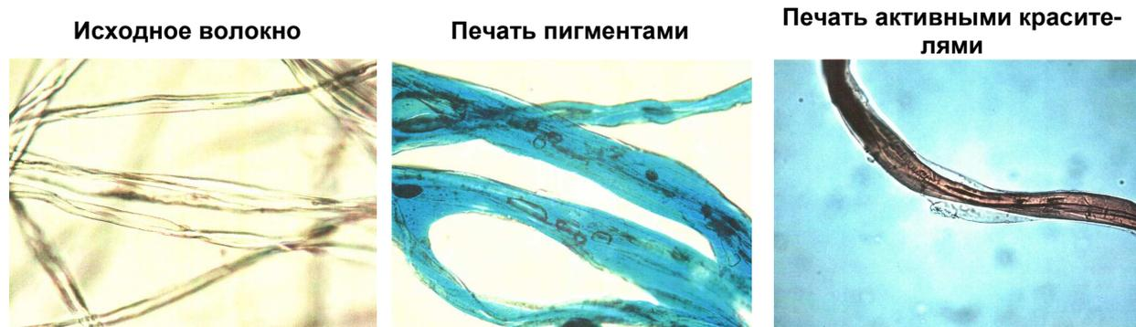
Рисунок 6 – Микрофотографии целлюлозного волокна до и после процессов печатания.
