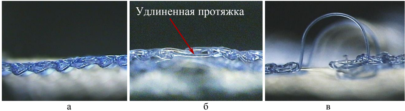
Рисунок 4 – Структура спроектированного переплетения из ПП мононитей d=0,07 мм после термофиксации в разрезе: исходное (а), с удлиненными протяжками при сдвиге ушковой гребенки на один (б) и три игольных шага (в)
