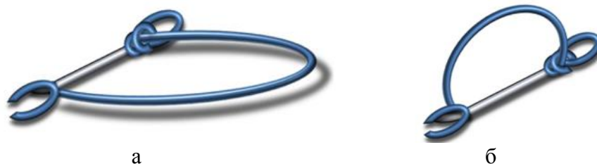
Рисунок 2 – Схема положения удлиненной протяжки до термофиксации (а) и после (б)
