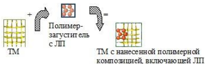
Рисунок 1. Схема получения лечебных текстильных аппликаций
