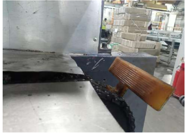
Рисунок 4.7. Изготовленная из древесно-полимерного композита лопатка, работающая на линии по производству литой тары из макулатуры
