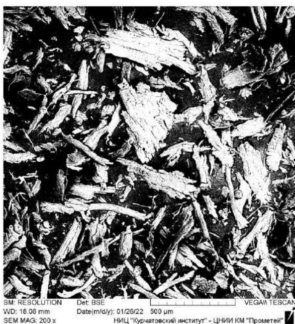
Рисунок 3.14 – Результаты сканирующей электронной микроскопии измельчённых частиц древесных из лиственницы
