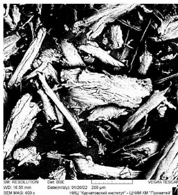
Рисунок 3.14 – Результаты сканирующей электронной микроскопии измельчённых частиц древесных из лиственницы
