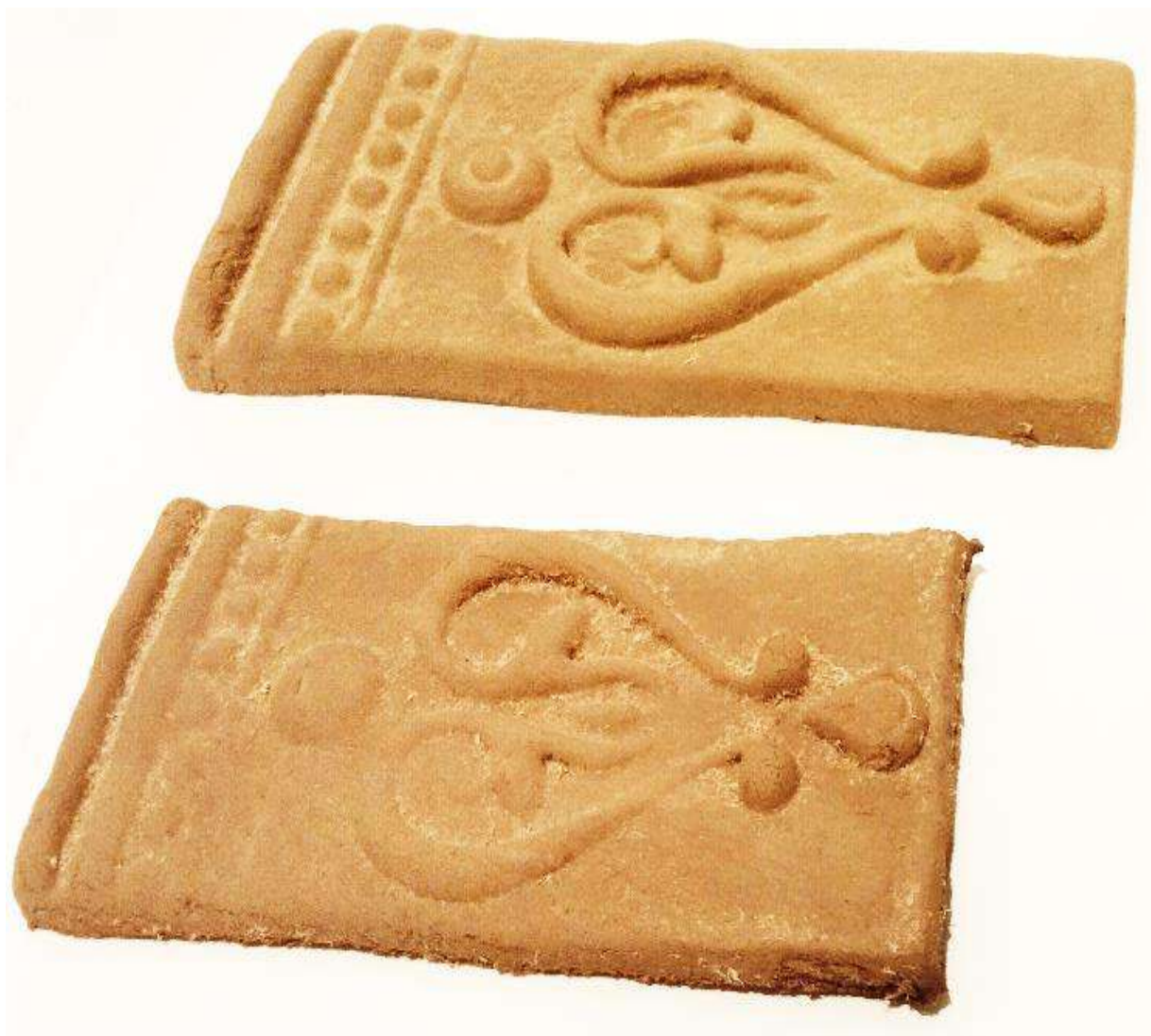
Рисунок 4.1 – Готовые изделия, полученные нанесением жидкого древесно-полимерного композита с формированием контура из пластика
