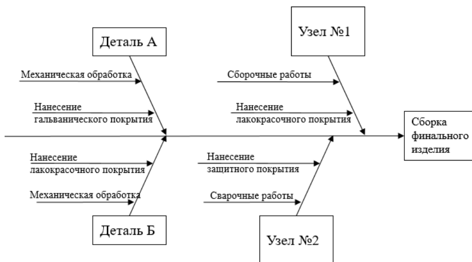
Рисунок 3.3 – Диаграмма изготовления изделия
