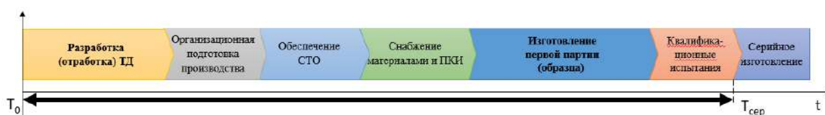
Рисунок 2.7 – Последовательное выполнение процессов постановки на производство
