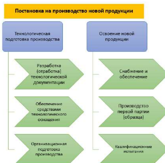
Рисунок 1.5 – Процессная модель постановки на производство новой продукции
