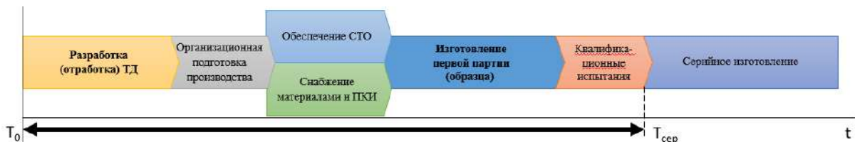
Рисунок 2.8 – Пример распараллеливания выполнения процессов постановки на производство
